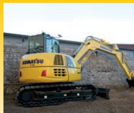
Um raio de rotação frontal reduzido juntamente com a função de rotação da base da lança, permitem maior versatilidade
