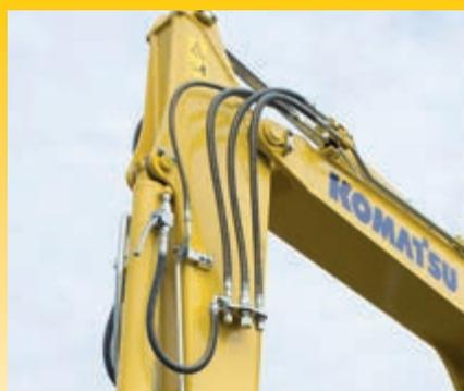
Linha hidráulica de 1 ou 2 vias para acessórios e linha de engate rápido hidráulico como equipamento de série
