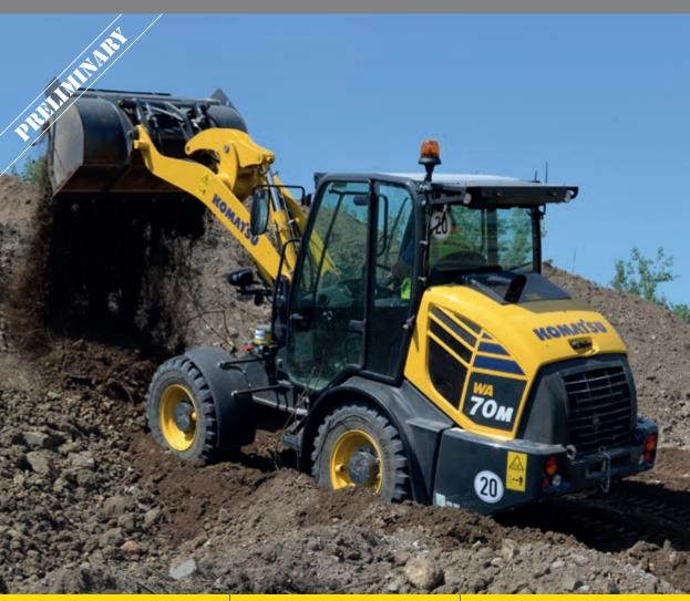
**ENGINE POWER** 46,2 kW / 62,0 HP @ 2.200 rpm **OPERATING WEIGHT** 4.980 - 5.300 kg **BUCKET CAPACITY** 0,75 - 1,25 m<sup>3</sup>
