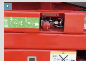
Válvula de descida manual: quando o sistema operativo falha ou a carga da bateria está muito fraca para deixar a plataforma descer, podemos usar esta válvula para baixar a máquina.
