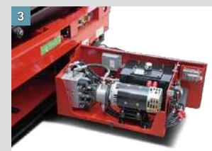
Sistema hidráulico e elétrico
