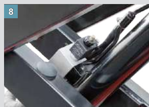
Válvula anti-rutura: para prevenir a queda da máquina, quando há rutura do tubo de óleo.
