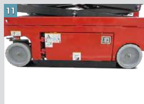
Sistema anti-capotamento: quando a máquina levanta mais de 2 metros, este sistema funciona automaticamente, para evitar o capotamento da máquina, enquanto se movimenta em terrenos desnivelados.
