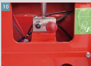
Válvula de desbloqueio manual: quando não se consegue movimentar a máquina, podemos empurrá-la, depois de pressionarmos esta válvula.
