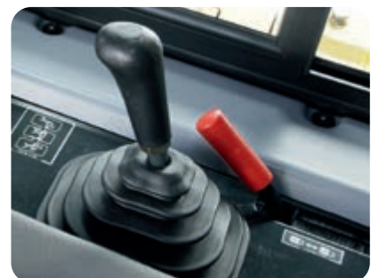
Alavancas de segurança de acionamento remoto
