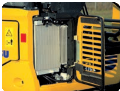
Capot direito: inspecção simples e limpeza dos radiadores
