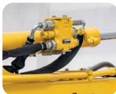
Válvulas de rotação da mangueira no cilindros da lança e do braço
