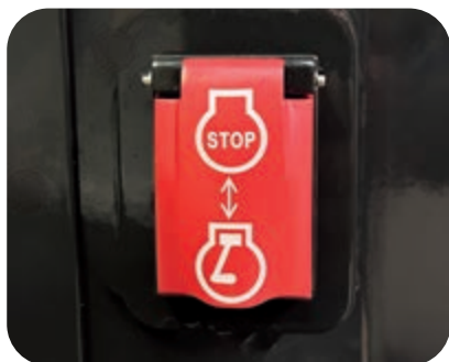
Interruptor de paragem de emergência do motor
