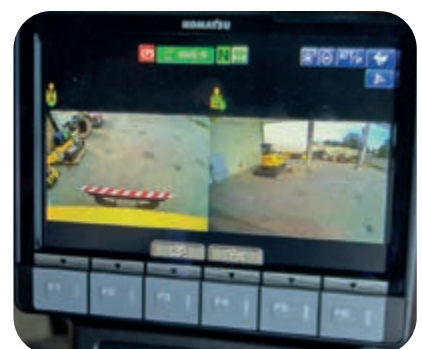
Sistema de câmara de vista lateral e retrovisora
