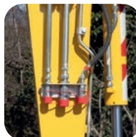
Circuitos hidráulicos adicionais (equipamento opcional)
