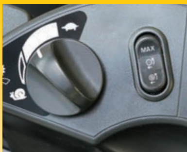
Variador de velocidade, com gama de velocidade super lenta (esquerda) e interruptor (direita) de controlo variável para o sistema de controlo de tracção
