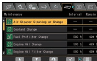
O monitor multi-funções permite visualizar e controlar diversas informações operacionais e de manutenção
