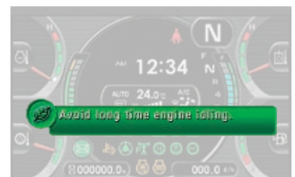
A eco-guia apoia a poupança de energia em tempo real (por exemplo, evita o funcionamento do motor em marcha lenta sem carga durante muito tempo)
