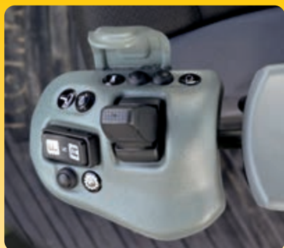
Alavanca curta de direcção da Komatsu (K-SLS) (opcional)
