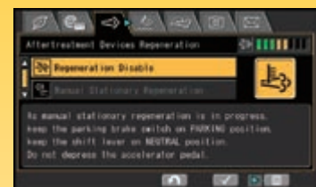
Ecrã de regeneração de pós-tratamento para o Filtro de Partículas Diesel da Komatsu
