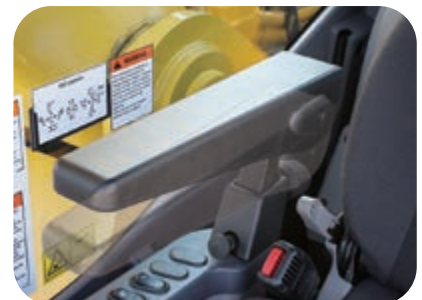
Apoio de braço com ajustamento de altura simples
