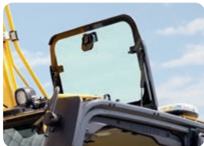
Novo teto de abrir de policarbonato com estore de enrolar para proteção do sol
