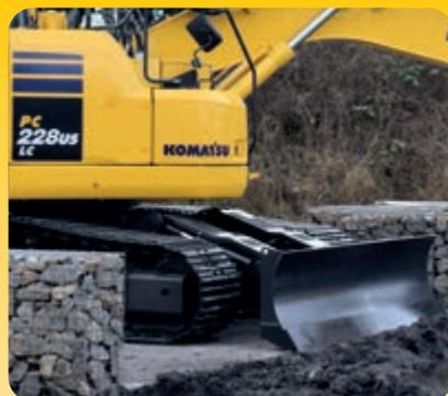
Lâmina dozer (opcional) adequada para sapatas de garra tripla (ferro) e sapatas road liner (borracha) de 600 mm
