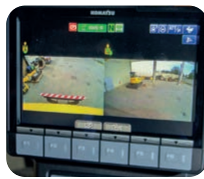
Sistema de câmara de vista lateral e retrovisora
