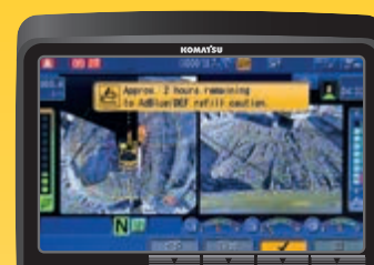
Nível de AdBlue® e orientação de reabastecimento
