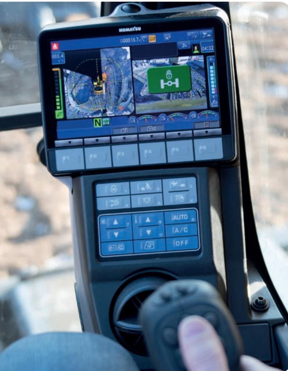
Equipada com tubagem universal para acessórios tais como martelos, a conversão para um modo de baixa pressão requer apenas a pressão do interruptor do modo de martelo no painel do monitor.
