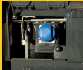
O depósito de AdBlue®, combustível e óleo hidráulico são facilmente acessíveis na parte lateral da máquina e reabastecidas ao nível do solo, garantido uma operação sem fadiga
