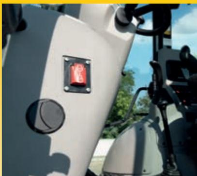
Interruptor de paragem de emergência do motor
