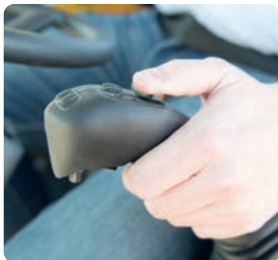
Alavancas de comando ergonomicamente concebidas com comandos proporcionais
