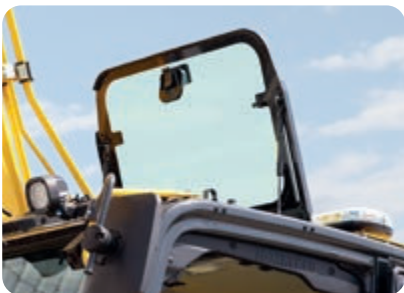
Novo teto de abrir de policarbonato com estore de enrolar para proteção do sol
